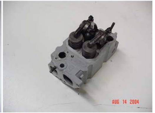
1134 1331 199 D190 rebuilt cylinder head.jpg
